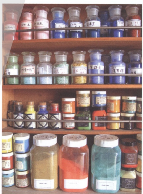
圖25 各種色粉與水干顏料 上二排為水干顏料，許多化學生產的無機色粉、有機色粉在顏料的質感、耐光性、色彩種類上，都比水干顏料佳。 （圖片來源：高永隆拍攝）
