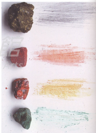
圖7 不同礦石的條痕色澤，由上而下分別是銅礦、朱砂礦、雞冠石、孔雀石。 (圖片來源：高永隆拍攝)
