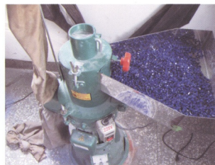
圖5 筆者製作青金石末，以現代碎石機粉碎硬度的青金石。(圖片來源：高永隆拍攝)
