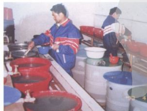
圖6 雖然現代製色技術精進，但水飛漂洗的方法，仍是製作天然礦物顏料的主要步驟。 (圖片來源：高永隆拍攝)
