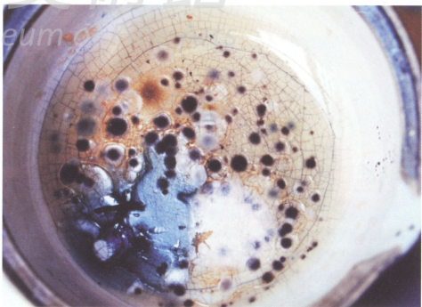
圖29 動物膠腐敗發霉的現象 水解的動物膠雖提供礦物顏料良好的發色，但其纖維蛋白質在潮溼高溫環境下，極易發霉腐敗而喪失黏性。 （圖片來源：高永隆拍攝）
