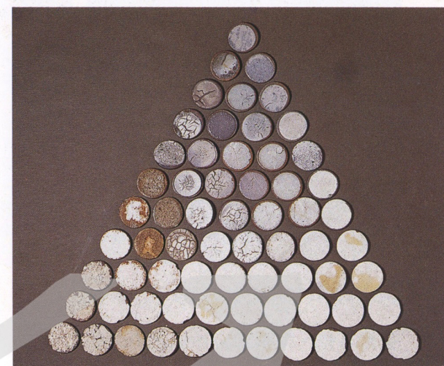
三角實驗表的燒成情況，可看出溫度和原料性質不同時的釉藥變化。 (取材自雄獅出版《陶藝技法123》)
